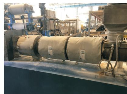
Тестирование термоизоляционных чехлов на экструдере Theysohn TTM 138
