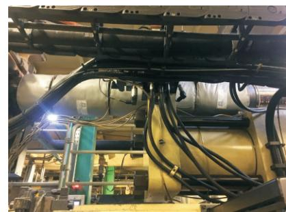
Тестирование термоизоляционных чехлов на ТПА Haitian Mars 2000
